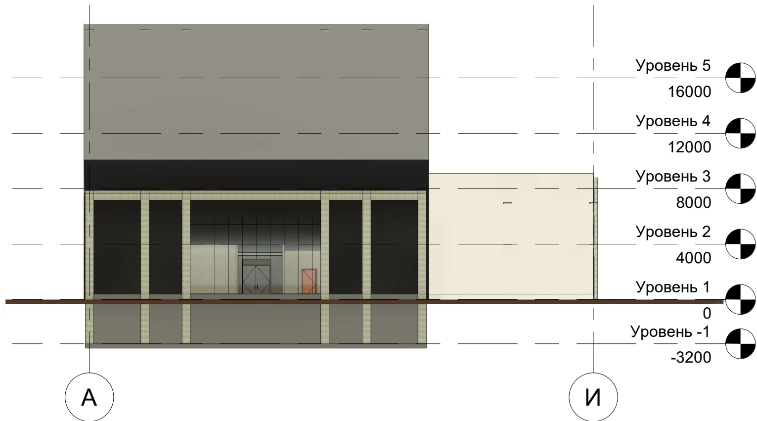
Фасад в осях А-И М1:200
